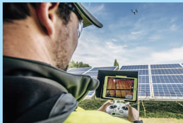
Inspección aérea termográfica. © BayWa r.e.
