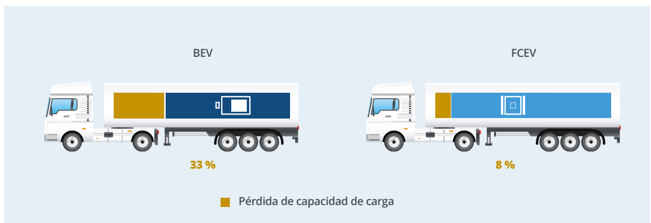
Figura 1-2. Pérdida de capacidad de carga por el sistema de almacenamiento de energía para BEV (izquierda) y FCEV (derecha).
